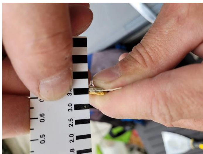
Obr. 6. Na neporušeném místě omítky byl odebrán vzorek a změřena tloušťka omítky (základní vrstva činí 2 mm, vnější povrchová omítka 1,5 mm, dohromady tedy 3,5 mm).
